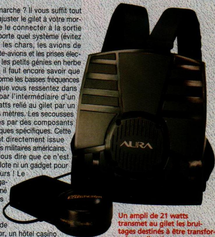
**Un ampli de 21 watts transmet au gilet les bruits destinés à être transformés en vibrations.**
