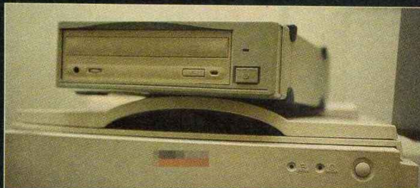
Le graveur est posé sur le scanner. Avec ces deux outils de travail, il est possible de reproduire un original à l'identique, jaquette comprise.
