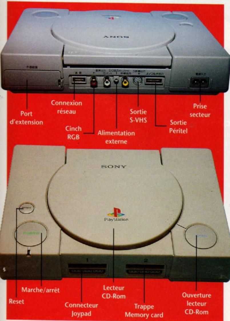
Port d'extension    Connexion réseau    Sortie S-VHS    Prise secteur
