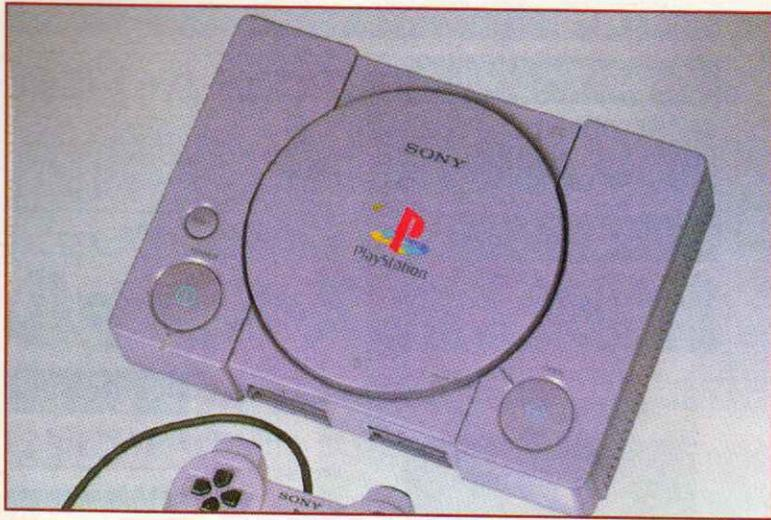
architecture multiprocesseur. Tant mieux, c'est la plus efficace ! Le processeur principal (le R 3000, un 32 bits RISC cadencé à 33 MHz) est secondé par une batterie de copros en tout genre, chargés par exemple des opérations de compression/décompression de données ou des calculs 3D. Le tout dégageant — dicit Sony — une puissance de calcul phénoménale.
